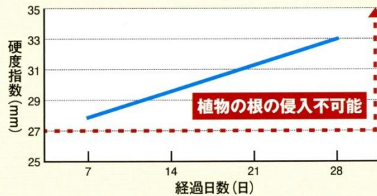
山中式土壌硬度計によるマグナイト土壌硬度測定
